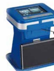
目視困難な生産設備表面上の食品残渣をふき取り検査・培養検査よりも迅速かつ無試薬で可視化できます。
