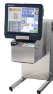
“コントロールできない、ヒューマンエラーへの答え。” LIS-S800はこれまで目視でしかできなかった、ラベル印字内容の検査を高解像度 CCDカメラにより完全自動化。
