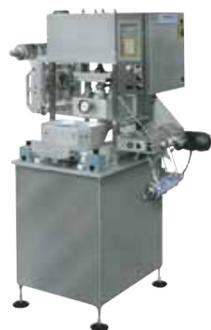
トレーシーラーの手動タイプ。包装バリエーションは高速タイプと同様にガス充填、スキンパックも可能です。型交換も簡単です。
